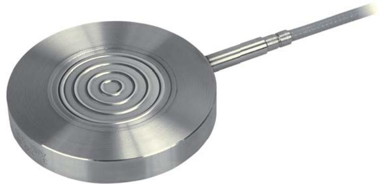
Druckmittler sind Trennvorlagen, die ein Eindringen von korrosiven, viskosen, aggressiven oder zu heißen Prozessmedien in das Messelement eines Druckmessgerätes verhindern. Die eingeschweißte Membran trennt die Übertragungsflüssigkeit zuverlässig vom Druckmessgerät. Das Druckmessgerät wird über eine Fernleitung (Länge bis zu 6 m) angeschlossen. Zellendruckmittler Typ MGS9/WAFER werden in Flansche passender Nennweite (EN 1092 oder ASME) eingespannt.
